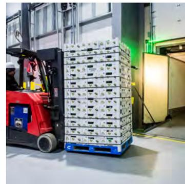
Antes del proceso de carga, el camión debe inspeccionarse para asegurar que está limpio y en condiciones operativas adecuadas de acuerdo con las reglamentaciones de inocuidad de productos. Asimismo, es esencial que el camión ya se encuentre enfriado a la temperatura de embarque correcta. Una temperatura incorrecta al momento de realizar la carga será difícil de rectificar sin afectar la temperatura de la fruta.
